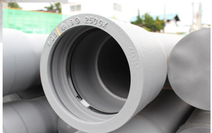
老朽管から「耐震管」へ布設替を行っています
