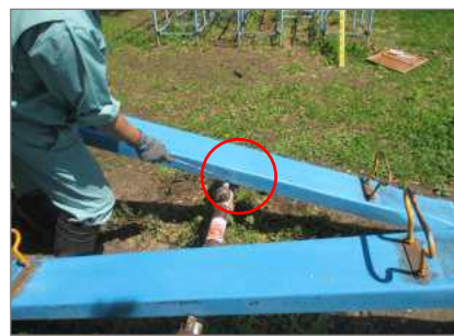
シーソー腕部の亀裂
